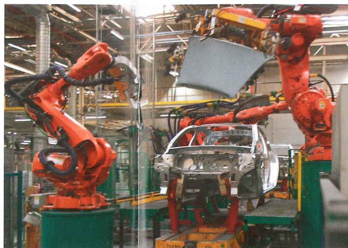
Pose d'un pavillon de toit au département Tôlerie.
